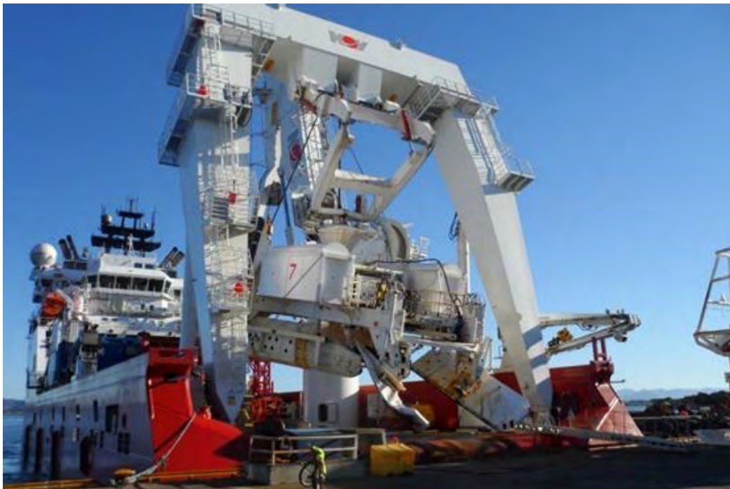
Figure 3-11 Backfill plough (Subsea7)
